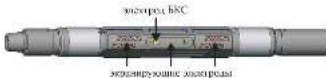
Рисунок 1 – Внешний вид прибора БКС, входящего в состав комплекса «ЛУЧ-М» для каротажа в процессе бурения
